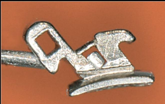
*Imagen de un tubo de una conocida marca que muestra las deficientes características del slot y la falta de forma rectangular de un arco .019" x .025" de acero. Explicación evidente de la falta de eficiencia para producir torque.*
