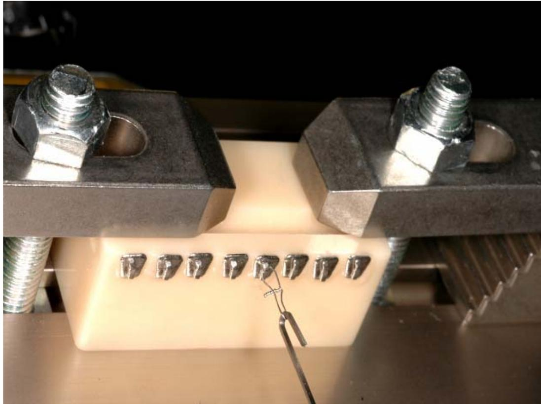
*Detailansicht der Bracketbelastung. Durch den geschlossenen Slot des 2D Lingual-Brackets führt eine Drahtschleife, welche die Verbindung zum Zughaken der Messzelle herstellt.*
